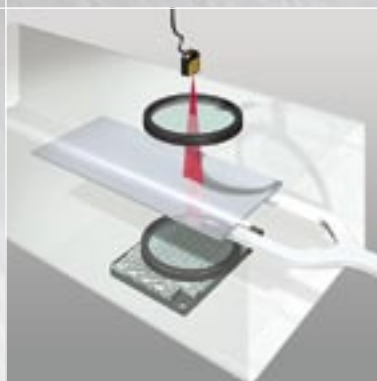
Обнаружение стеклянной заготовки через смотровой люк
