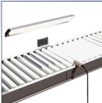
Импульсная синхронизация для невосприимчивости к окружающему освещению.
