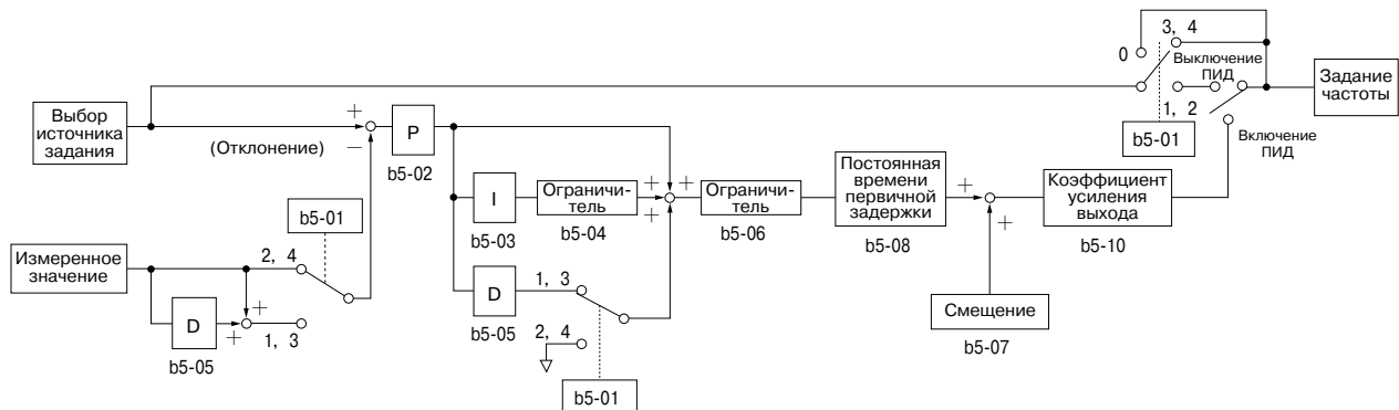
Структурная схема ПИД-регулятора
