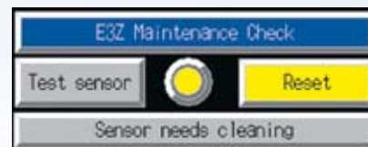
Пример интеллектуального активного компонента для обслуживания E3Z.
