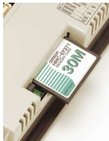
Простая передача данных с помощью карты памяти Compact Flash объемом 30 Мбайт
