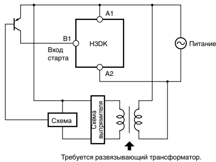
Требуется развязывающий трансформатор.
