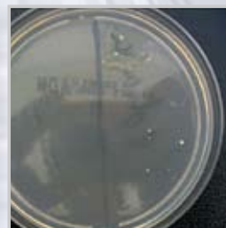
Активное подавление бактерий на корпусе датчика E2F-D по прошествии 12 часов.
