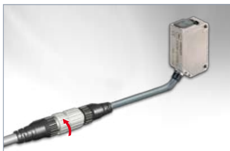
Twist-and-click (Поверни и защелкни) разъем M12 со встроенным кабелем: достаточно поворота на 1/8-ю и разъемы защелкнуты
